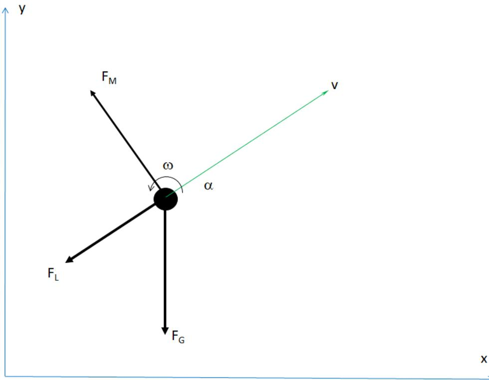
Im Folgenden werden für einen Abschusswinkel  $\alpha := 40^\circ$  und Anfangsgeschwindigkeit  $v_0 = 30 \text{ m/s}$  die Flugbahnen von Bällen mit dem im Fußball häufig anzutreffenden Backspin (wenn, der Ball unter dem Schwerpunkt vom Fuß getroffen wird zB beim Abstoß) mit dem Topspin (beim Fußball eher selten - siehe Tennis) und der neutralen Flugbahn ohne Magnuskraft verglichen. Die Drehgeschwindigkeit ist  $\omega := 3 \text{ rad/s}$
