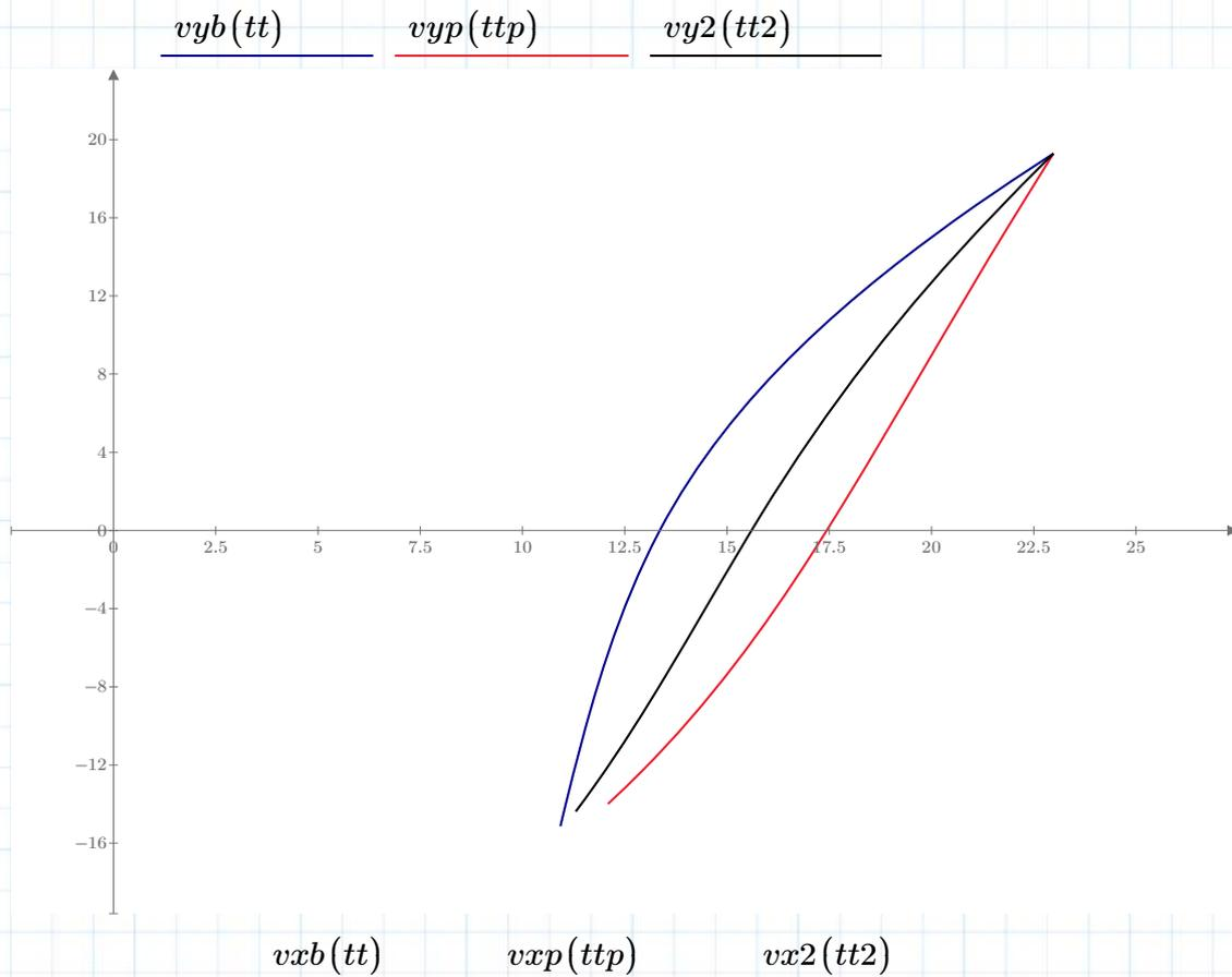
Die Krümmung der Geschwindigkeitskurven bei Backspin und Topspin ist unterschiedlich. Daher nimmt  $v_x$  bei Backspin vor allem anfangs sehr stark ab, bei Topspin eher zum Ende der Flugbahn. Die Aufprallgeschwindigkeiten sind wieder relativ ähnlich.
