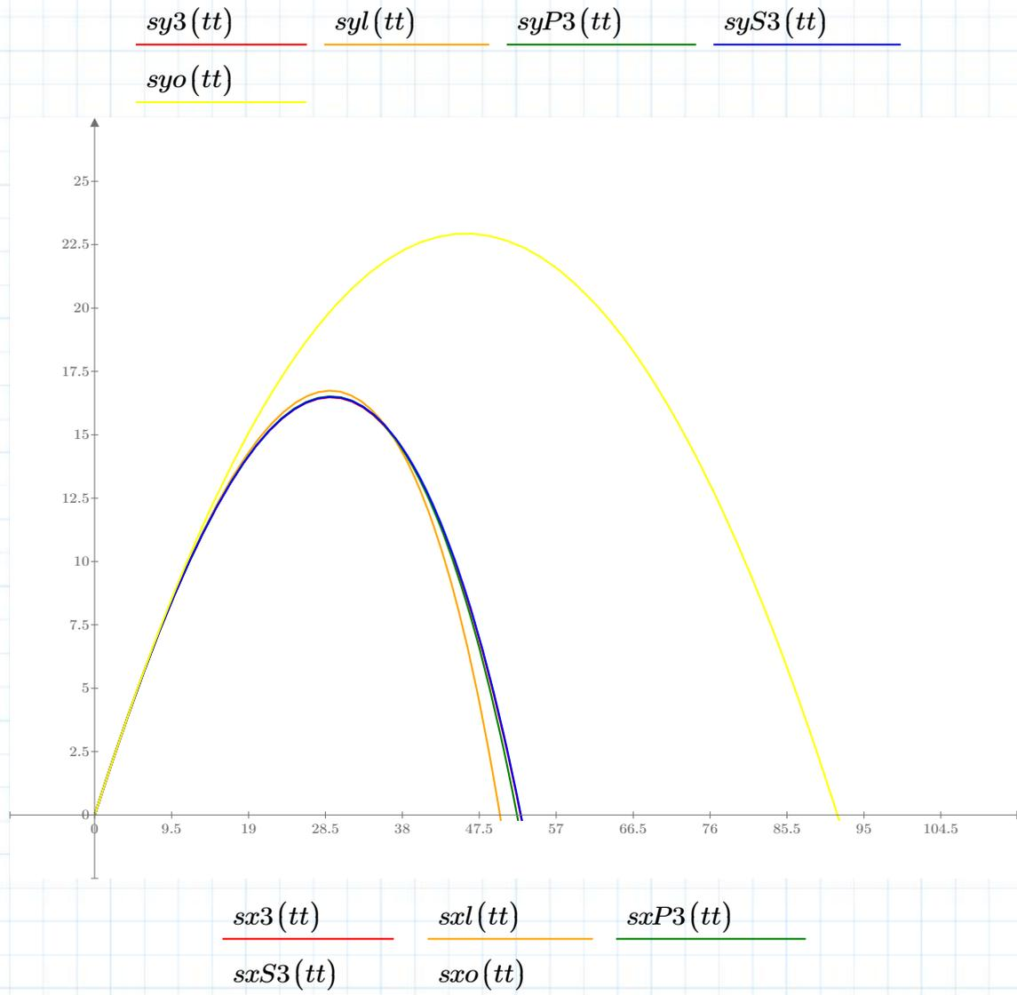
Die dargestellten Bahnkurven für den Abwurfwinkel 45° zeigen, dass die Wurfparabel unrealistisch ist und auch das Modell der Stokeschen Reibung etwas abweicht. Die anderen Varianten liefern relativ ähnliche Verläufe. Klar erkennbar ist auch der durch den Luftwiderstand bedingte steilere Abfall im Vergleich zur Wurfparabel.
