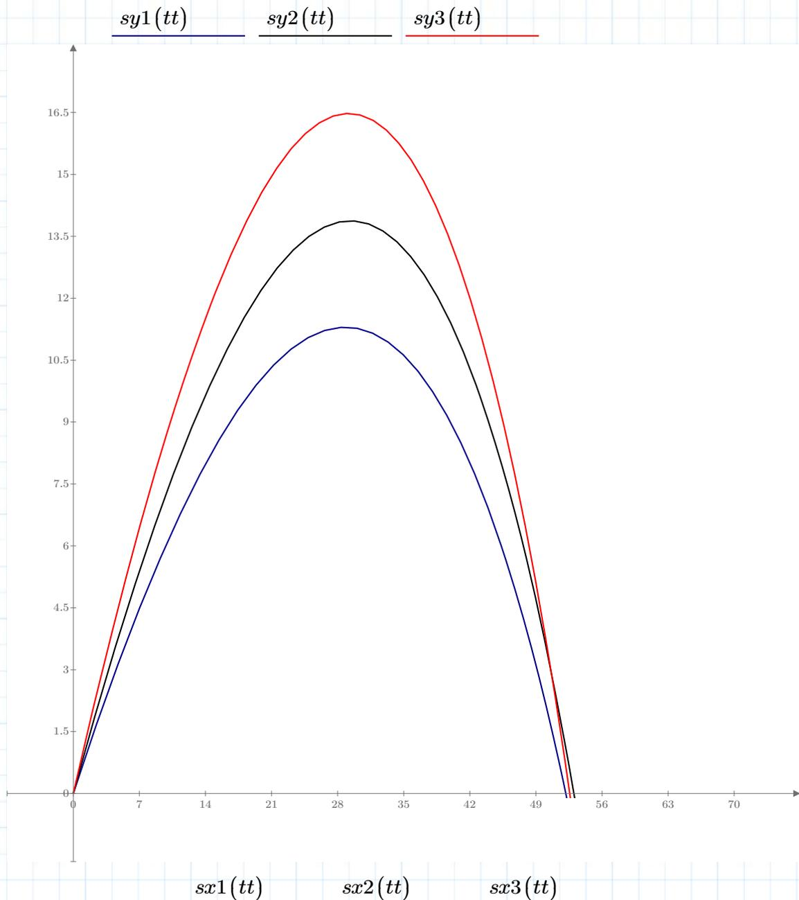
Trotz verschiedener Abwurfwinkel sind im Bereich von  $35^\circ - 45^\circ$  die Wurfweiten relativ ähnlich. Die maximale Wurfweite hat in diesem Bereich ein schwach ausgeprägtes Maximum, dessen Stelle je nach Wahl der Parameter leicht variiert. Da das Bestimmen der einzelnen Parameter relativ ungenau ist, erscheint die Angabe eines Bereichs für den Abschusswinkel der maximalen Wurfweite durchaus sinnvoll.
